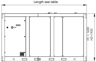
Length L2 L3 HEAT PUMP ONLY 1240 2100 3950 1790 3450 6050° HEAT PUMP + 1 MODULE HEAT PUMP + 2 MODULES 2480\* 3950 HEAT PUMP + 3 MODULES 3030\* 6050\* HEAT PUMP + 4 MODULES 3580\* 6050\* request \*2480 = 1240+1240 \*3030 = 1240+1790 \*3580 = 1790+1790 \*6050 = 3950+2100 \*7900 = 3950+3950
